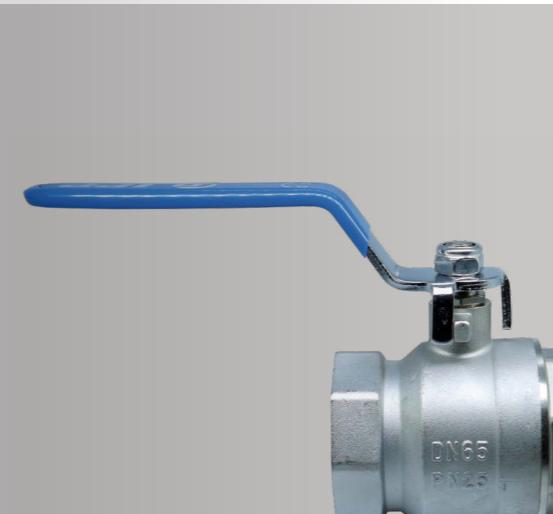
Passagem plena, corpo em latão jateado e niquelado, extremidades BSP conforme ISO 228/1 fêmea-fêmea, temperatura de trabalho de -10°C a +110°C, pressão máxima de trabalho 25 bar (PN25) a 80°C, acionamento alavanca de aço.
