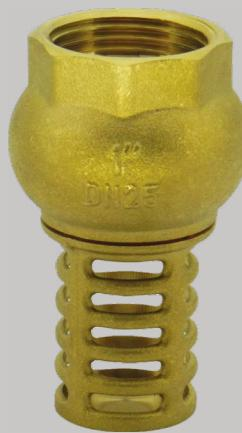
Válvula de retenção de fundo de poço (PÉ) latão BSP. Corpo em latão forjado e jateado. Extremidades BSP conforme ISO 228/1 fêmea-fêmea. Temperatura de trabalho de -10°C a +110°C. Pressão máxima de trabalho 16 bar (PN16). Vedaçao metal/metal.
