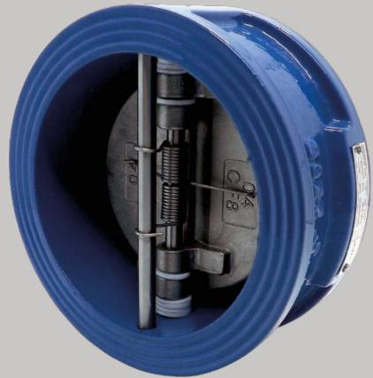
Usada para impedir o retorno do fluido na tubulação, podendo ser aplicada nas posições vertical, horizontal ou inclinada. Corpo em ferro fundido GG 25, assento e vedação NBR, eixo em aço inoxidável 416 e mola em aço inox 304; Calço PTFE e plug WCB; Montagem entre flanges ANSI 150. Temperatura de trabalho de 0°C a 90°C, pressão mínima de abertura 0,08 Mpa (0,8 bar).
