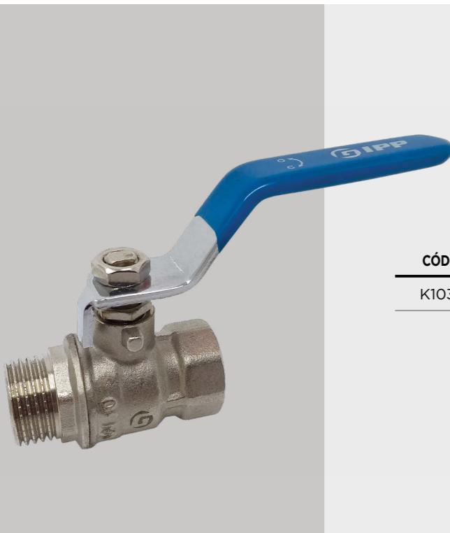
Passagem standard, corpo em latão jateado e niquelado, extremidades BSP conforme ISO 228/1 macho-fêmea, temperatura de trabalho de -10°C a +110°C, pressão máxima de trabalho 30 bar (PN30) a 80°C, vedação do assento PTFE, acionamento alavanca de aço.
