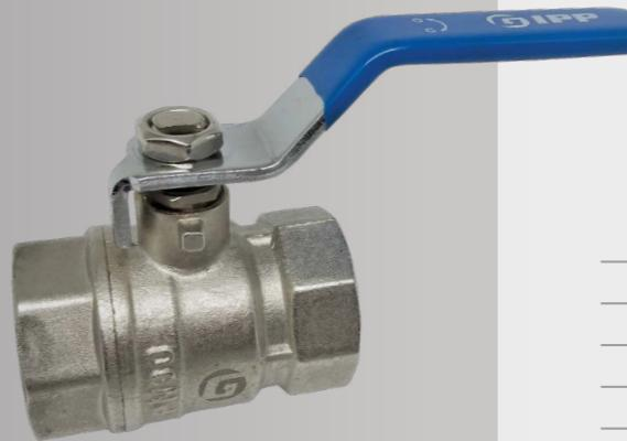
Passagem standard, corpo em latão jateado e niquelado, extremidades BSP conforme ISO 228/1 fêmea-fêmea, temperatura de trabalho de -10°C a +110°C, pressão máxima de trabalho a 80°C 30bar (PN 30), para 1/4", 3/8", 1/2", 3/4", 1", 1 1/4", 1 1/2", 2", 2 1/2", 3"; 25 bar (PN 25) para 4", vedação do assento PTFE, acionamento alavanca de aço.
