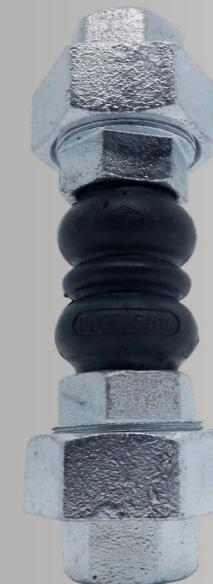
Unões em ferro maleável galvanizado; Extremidades rosca BSP ISO 7.1; Corpo em EPDM com alma interna em Nylon; Temperatura de trabalho de 0°C a 80°C; Pressão máxima de serviço 16 bar a 50°C / 10 bar a 60°C; Vácuo máximo admissível 500 mm/hg; Comprimento 200 mm de 1/2" a 2"; 240 mm para 2.1/2" e 3".
