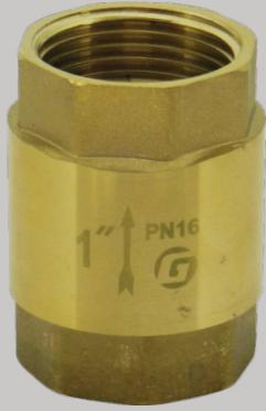
Corpo em latão forjado, acabamento superficial, extremidades BSP conforme ISO 228/1 fêmea-fêmea, temperatura de trabalho -10°C a 110°C. Pressão máxima de trabalho 16 bar (PN 16).
