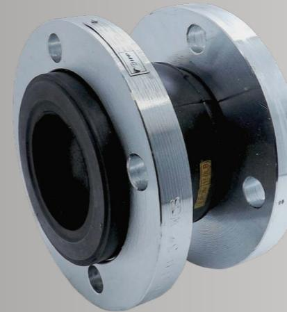
Flanges em aço carbono WCB conforme ANSI B16.5 classe 150; Montagem entre flanges ANSI 150; Corpo simples onda em borracha EPDM com reforço em fio de aço para maior resistência; Classe 150 para pressões de trabalho máxima de 16 bar; Pressão de ruptura mínima a 3 MPa (30 bar), Pressão de trabalho 1,6 MPa (16 bar); Temperatura de trabalho de -20°C a 100°C.
