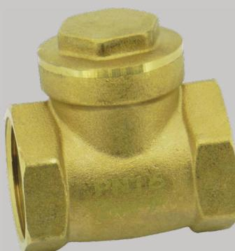
Corpo em latão forjado, jateado, extremidades BSP conforme ISO 228/1 fêmea-fêmea, temperatura de trabalho de -10°C a 110°C, pressão máxima de trabalho 16 bar (PN16), vedação metal/metal.
