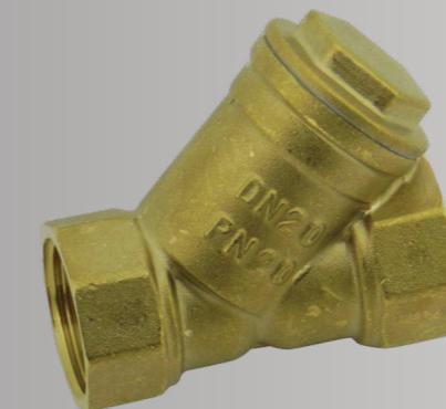
Construção em latão forjado jateado, extremidades BSP conforme ISO 228/1 fêmea-fêmea, temperatura de trabalho de -10°C a 110°C, pressão máxima de trabalho 16 bar (PN 16).
