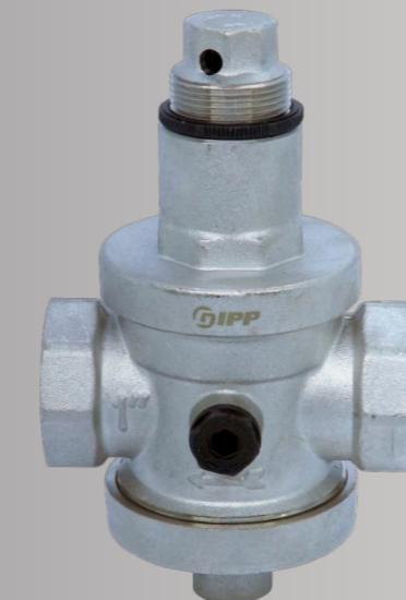
Corpo em latão forjado jateado. Extremidades BSP conforme ISO 228/1 fêmea-fêmea. Temperatura de trabalho de 0°C a +80°C. Pressão máxima de trabalho 16 bar (PN16). Setagem de fábrica para 3 bar. Regulável de 1 a 6 bar.
