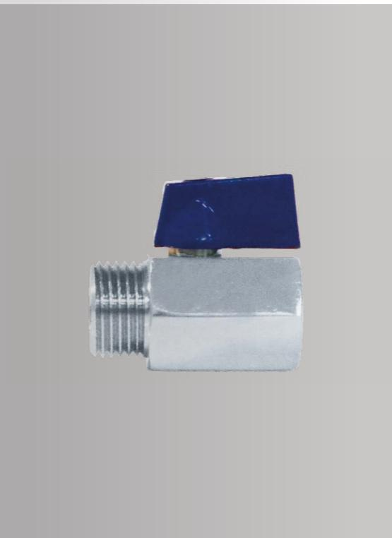
Passagem reduzida, corpo em latão forjado, polido e cromado. Extremidades BSP conforme ISO 228/1 macho-fêmea, temperatura de trabalho de -10°C a 110°C, pressão máxima de trabalho 16 bar (PN16) a 80°C, vedação do assento PTFE.
