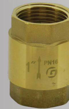
Corpo em latão forjado com acabamento superficial. Extremidades BSP conforme ISO 228/1 fêmea-fêmea. Temperatura de trabalho de -10°C a +110°C. Pressão máxima de trabalho 16 bar (PN16). Disco, guia e eixo em latão.
