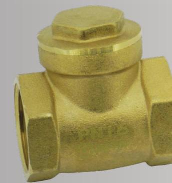
Corpo em latão forjado e jateado, extremidades BSP conforme ISO 228/1 fêmea-fêmea, temperatura de trabalho de -10°C a +110°C, pressão máxima de trabalho 16 bar (PN16), vedação metal/Buna-N.
