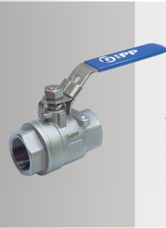
Usada para bloquear ou liberar o fluxo do fluido. Preferencialmente deve ser utilizada na posição totalmente aberta ou totalmente fechada (ON/OFF) para evitar desgaste prematuro.
