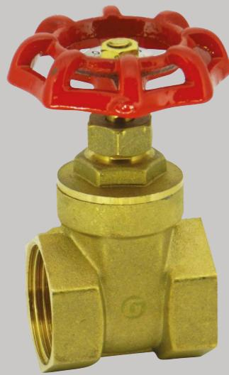
Construção em latão. Extremidades BSP conforme ISO 228/1, fêmea-fêmea, temperatura de trabalho de 0°C a 110°C, pressão máxima de trabalho 16 bar (PN16), vedação metal/metal.
