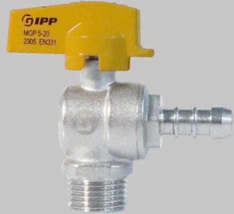
Válvula angular para gás combustível, conforme EN 331, Corpo em latão forjado, jateado e niquelado; Extremidades BSP conforme ISO 228/1 macho-bico mangueira; Temperatura de trabalho de -10°C a +80°C; Pressão máxima de trabalho 5-20 MOP; Duplo anel de vedação em NBR e vedação do assento PTFE; Acionamento com orifício para colocação de lacre.
