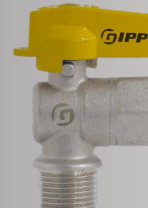
Válvula angular para gás combustível, conforme EN 331; Corpo em latão forjado, jateado e niquelado; Extremidades BSP conforme ISO 228/1 macho-fêmea; Temperatura de trabalho de -10°C a +80°C; Pressão máxima de trabalho 5-20 MOP; Duplo anel de vedação em NBR e vedação do assento PTFE; Açãoamento com orifício para colocação de lacre.
