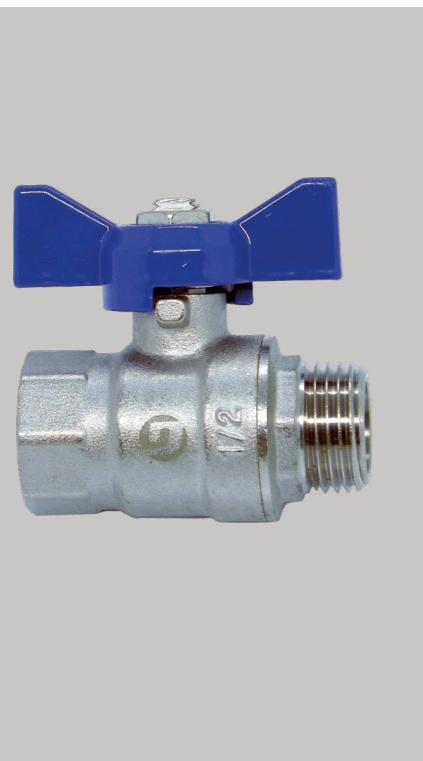
Passagem plena, corpo em latão jateado e niquelado. Extremidades BSP conforme ISO 228/1 macho-fêmea. Temperatura de trabalho de -10°C a +110°C. Pressão máxima de trabalho 40 bar (PN40) para 1/2 a 80°C. Pressão máxima de trabalho 30 bar (PN30) para 3/4 a 80°C. Vedação do assento PTFE.
