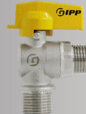
Válvula angular para gás combustível, conforme EN 331; Corpo em latão forjado, jateado e niquelado; Extremidades BSP conforme ISO 228/1 macho-macho; Temperatura de trabalho de -10°C a +80°C; Pressão máxima de trabalho 5-20 MOP; Duplo anel de vedação em NBR e vedação do assento PTFE; Açãoamento com orifício para colocação de lacre.
